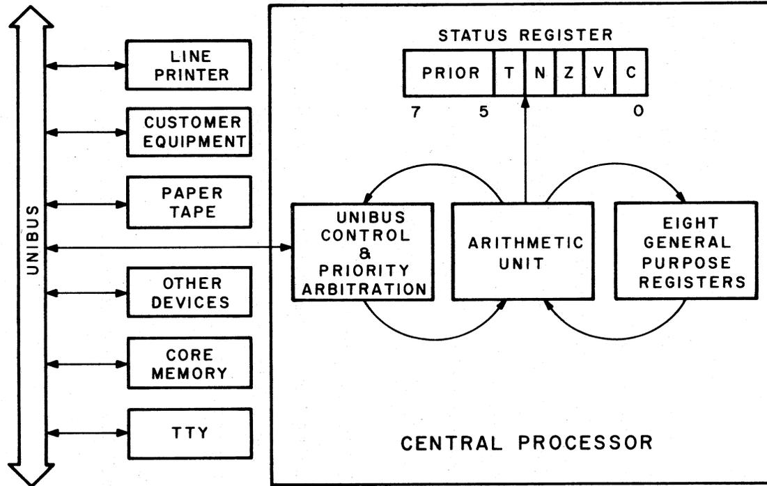
Figure 1-1. PDP-11 SYSTEM BLOCK DIAGRAM
