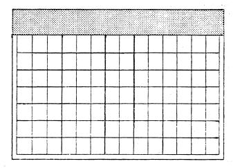
Figure 8-8. NMA Microfiche Format, 105x148mm, 98 Frames.
