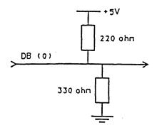
FIGURE 2.2.1 SINGLE-ENDED INTERFACE CIRCUIT
