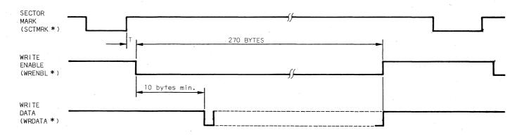
T=CONTROLLER RESPONSE TIME +PROPAGATION TIME (DRIVE TO CONTROLLER +CONTROLLER TO DRIVE TIMES). T MUST NOT EXCEED 1 usec.
