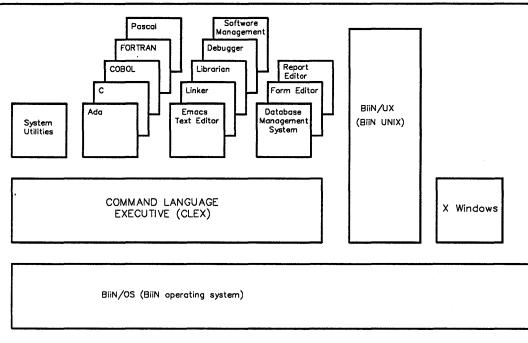
Figure 3-1. BiiN<sup>™</sup> Software
