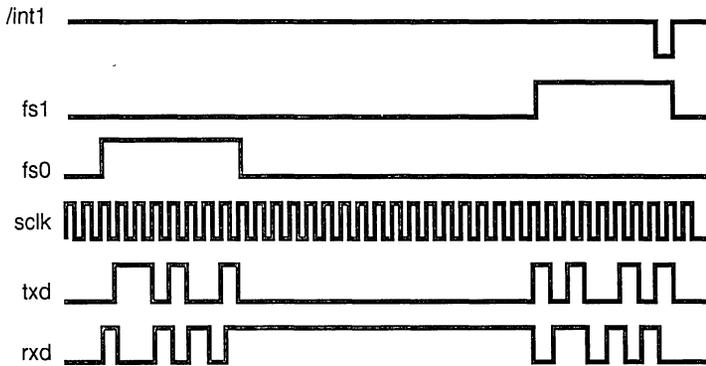
Figure 10. CODEC Interface Timing (8-Bit Mode)
