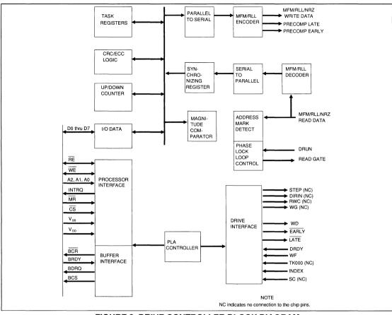
FIGURE 3. DRIVE CONTROLLER BLOCK DIAGRAM
