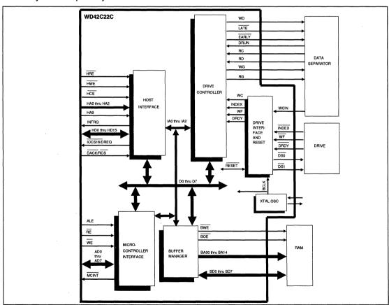
FIGURE 2. WD42C22C BLOCK DIAGRAM
