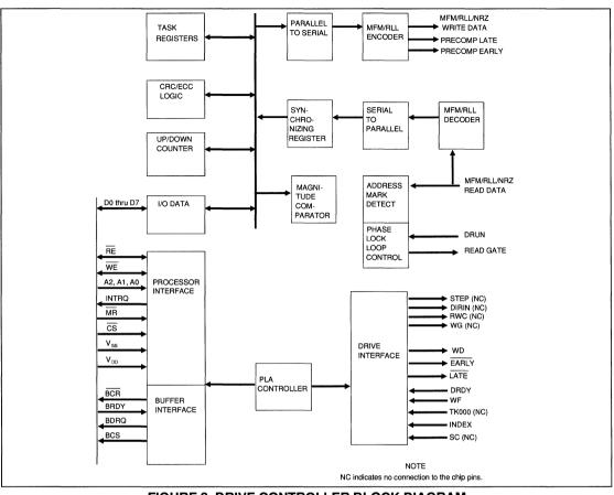
FIGURE 3. DRIVE CONTROLLER BLOCK DIAGRAM
