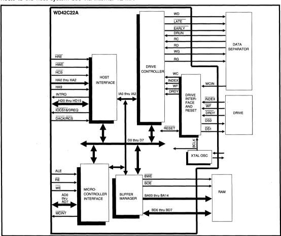
FIGURE 2. WD42C22A BLOCK DIAGRAM
