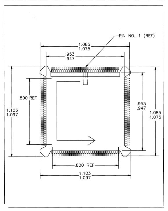
FIGURE 19. 132-PIN JEDEC PLASTIC FLAT PACKAGE (PFP) 1 OF 2
