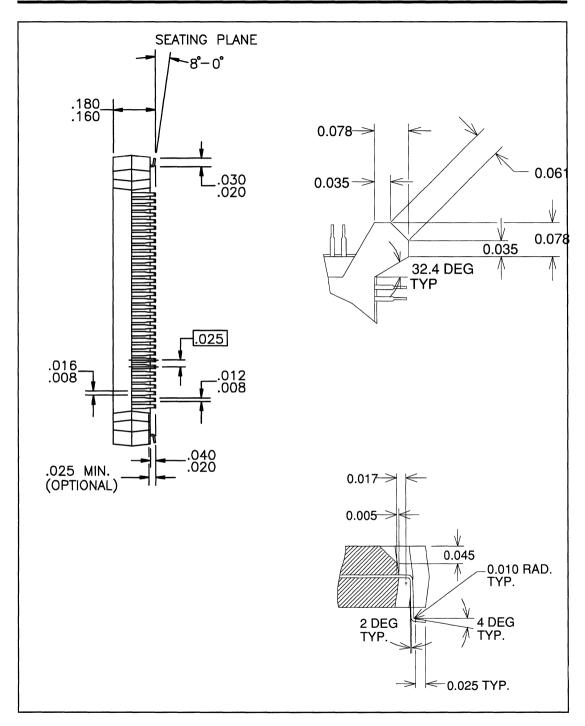
FIGURE 19. 132-PIN JEDEC PLASTIC FLAT PACKAGE (PFP) 2 OF 2
