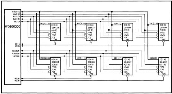
FIGURE 16. 1 MBYTE DRAM CONFIGURATION
