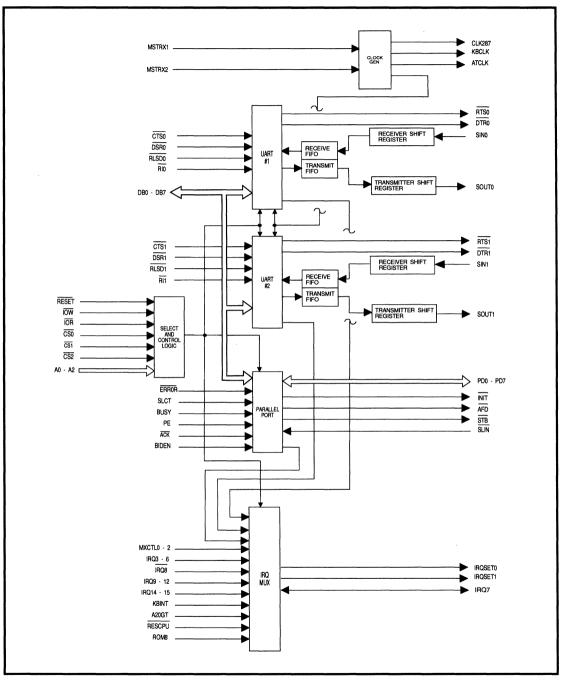
FIGURE 1-2. WD76C30 BLOCK DIAGRAM
