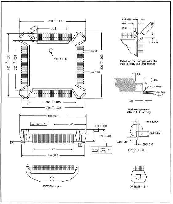
FIGURE 7-2. 84-PIN PQFP PACKAGE
