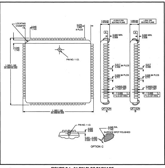
FIGURE 7-1. 84-PIN PLCC PACKAGE
