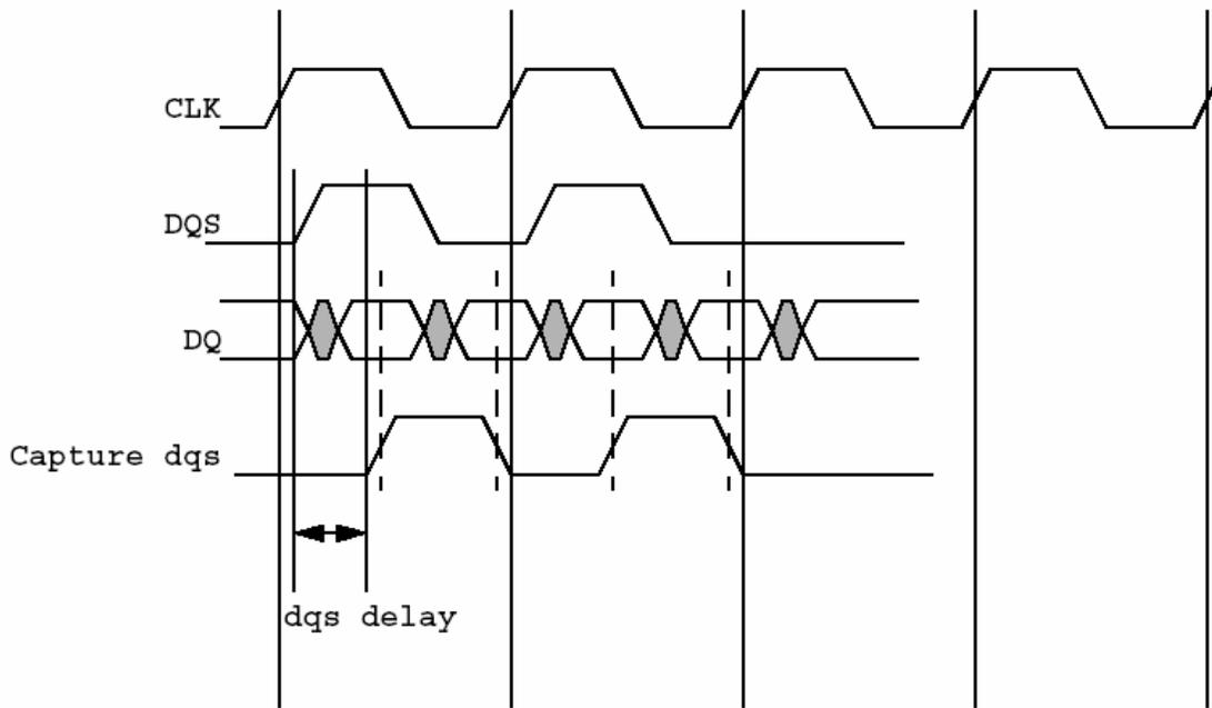
**Figure 15-10 dqs Read Timing**
