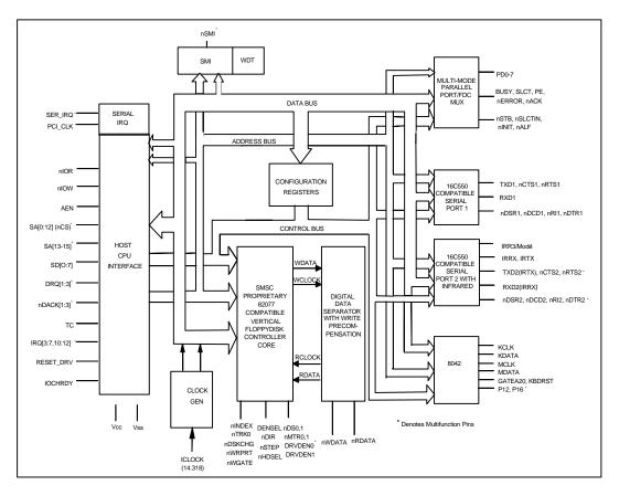
FIGURE 1 - FDC37C67x BLOCK DIAGRAM
