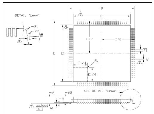
FIGURE 11 - 100 PIN TQFP PACKAGE
