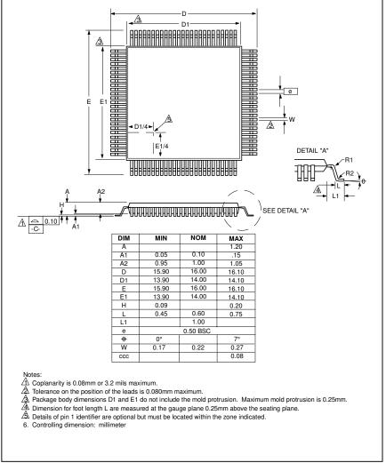
FIGURE 16 – 100 PIN TQFP PACKAGE OUTLINE
