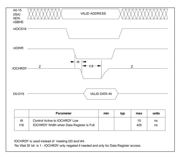
FIGURE 27 - DATA REGISTER SPECIAL WRITE ACCESS
