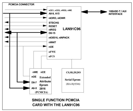
FIGURE 1 - LAN91C96 SYSTEM BLOCK DIAGRAM
