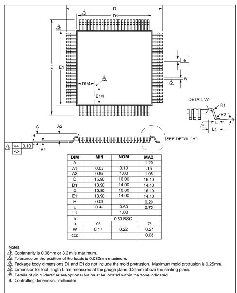
FIGURE 48 - 100 PIN TQFP PACKAGE
