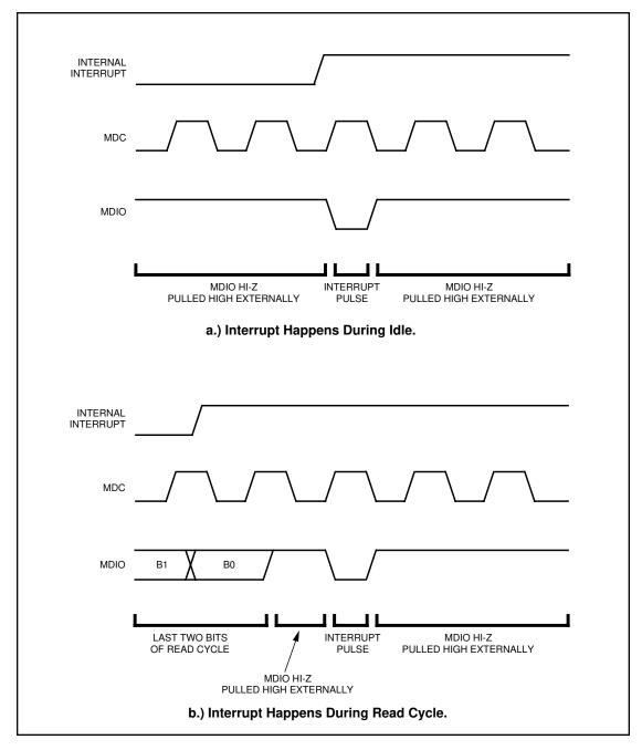
FIGURE 10 - MDIO INTERRUPT PULSE
