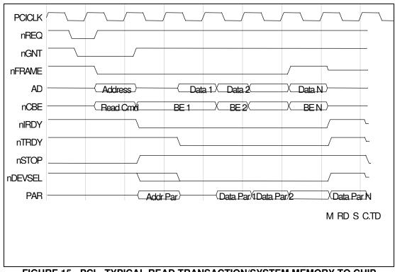
FIGURE 15 - PCI - TYPICAL READ TRANSACTION/SYSTEM MEMORY TO CHIP EPIC IS BUS MASTER
