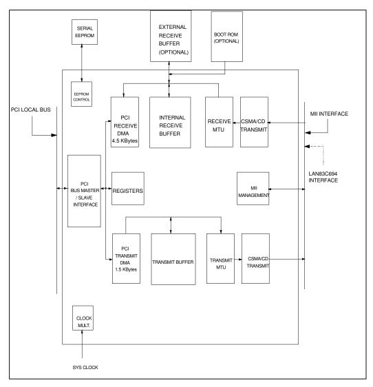
FIGURE 1 - LAN83C171 BLOCK DIAGRAM
