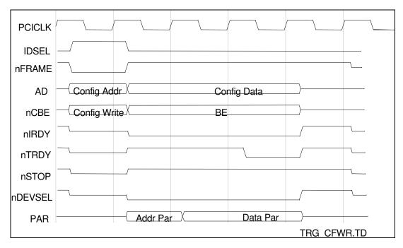
FIGURE 11 - PCI - TYPICAL CONFIGURATION WRITE/EPIC IS TARGET
