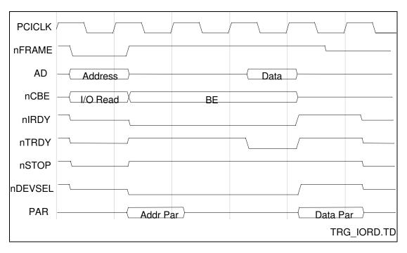
FIGURE 13 - PCI - TYPICAL I/O READ/EPIC IS TARGET
