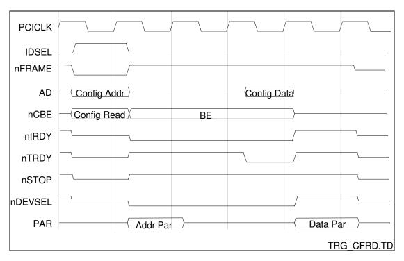
FIGURE 12 - PCI - TYPICAL CONFIGURATION READ/EPIC IS TARGET
