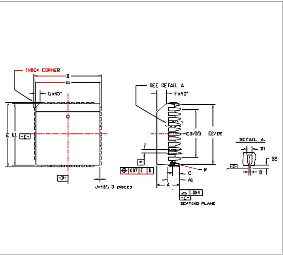
FIGURE 6-1. 44-PIN PLCC PACKAGE DIAGRAM
