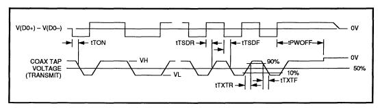
**FIGURE 2 : Transmit Function**
