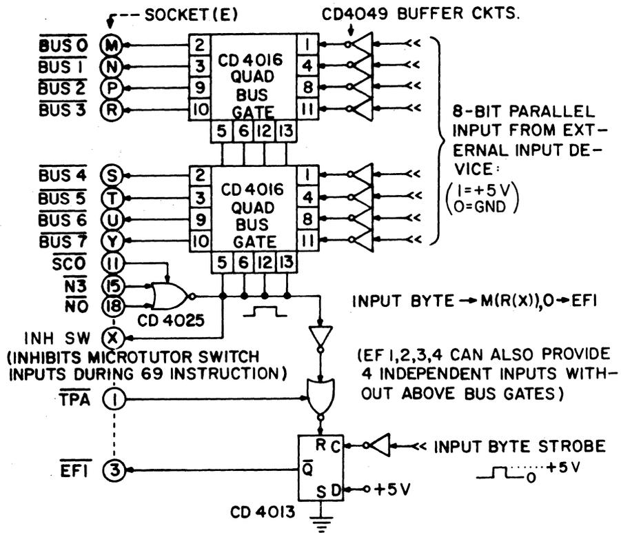
Fig. 7-Byte Input Circuit.
