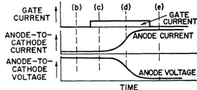
(f) CURRENT AND VOLTAGE WAVEFORMS DURING TURN-ON TRANSITION
