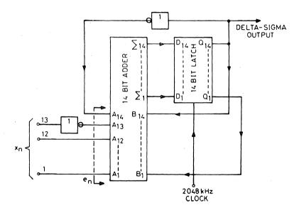
Fig. 10. Digital DSM Circuit Realisation
