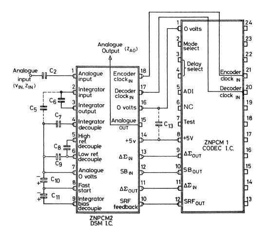
Fig. 4. DSM-Codec Interface
