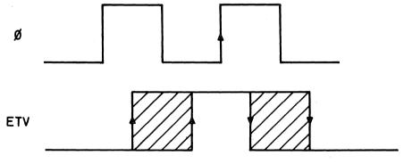
WAVEFORMS SHOWING ETV TOLERANCE
