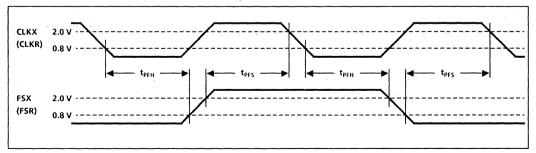
Fig. 24 Timing - PCM frame synchronisation
