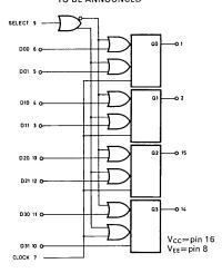
$P_D=275$ mW typ/pkg (No load)  $t_{pd}=2.5$ ns typ
