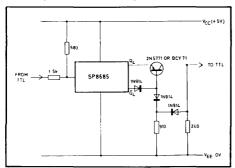
Fig. 5 TTL o/p - SP8685 PE i/p; SL8685 o/p - TTL i/p.
