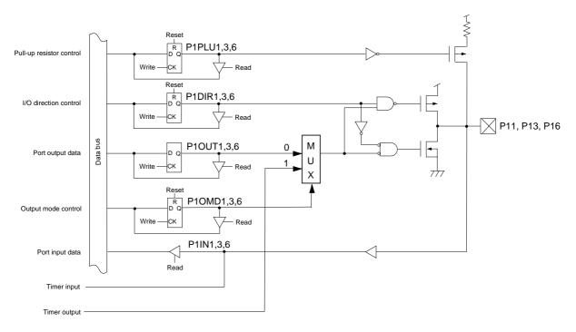
Figure 4-3-5 Block Diagram (P11, P13, P16)
