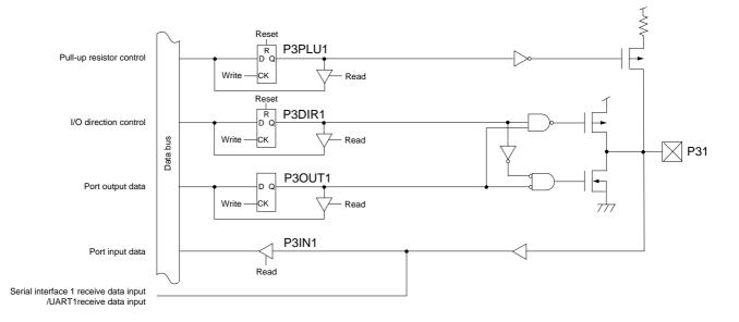
Figure 4-5-3 Block Diagram (P31)
