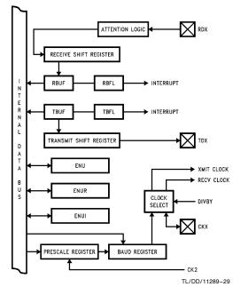
FIGURE 27. UART Block Diagram
