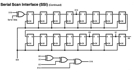
FIGURE 14. TDI SSC Block Diagram
