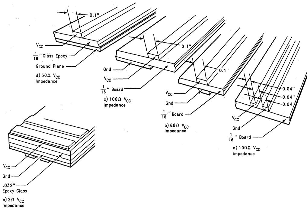
**FIGURE 4-1. Power Distribution Impedances**
