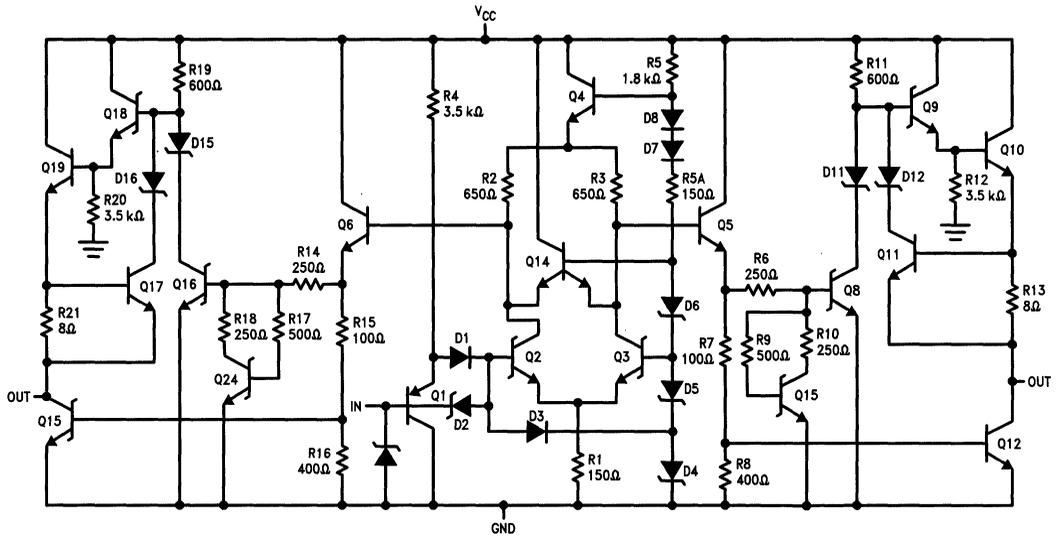
**FIGURE 1. Equivalent Circuit**
