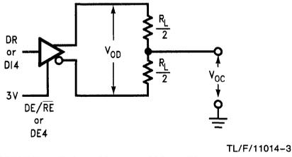
**FIGURE 1. Driver  $V_{OD}$  and  $V_{OC}$  (Note 13)**
