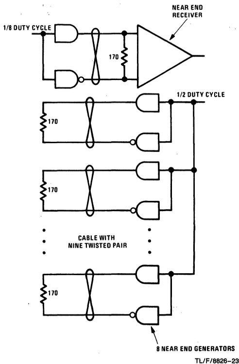
**FIGURE 25. Signal Cross Talk Experiment Using DS7830, DS7820A**
