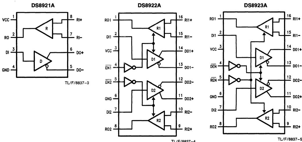
FIGURE 3. DS8921A, DS8922A and DS8923A Connection Diagrams
