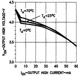
**Driver V<sub>OH</sub> vs I<sub>OH</sub> vs V<sub>CC</sub>**
