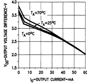
**Driver V<sub>OD</sub> vs I<sub>O</sub> vs V<sub>CC</sub>**
