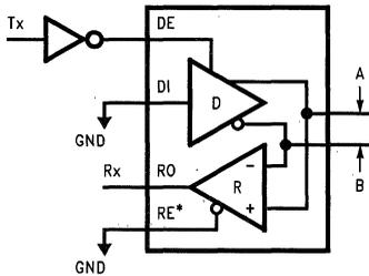
**FIGURE 4. The DS75176B in a SAE J1708 Application**
