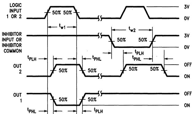
**FIGURE 3. AC Waveforms**
