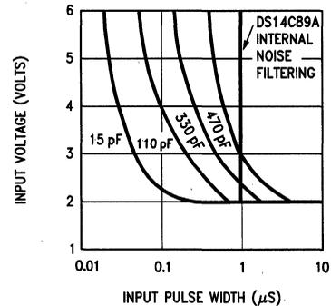
**FIGURE 7. Noise Rejection vs Capacitance for DS1489A**
