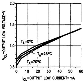
**Driver V<sub>OL</sub> vs I<sub>OL</sub> vs V<sub>CC</sub>**
