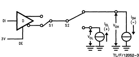
FIGURE 3. Driver V<sub>OH</sub> and V<sub>OL</sub>
