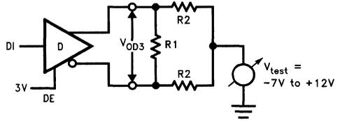
FIGURE 2. Driver  $V_{OD3}$
