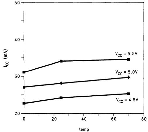
**FIGURE 6. DS3886A I<sub>CC</sub> vs Temperature (All B<sub>n</sub> Outputs High)**
