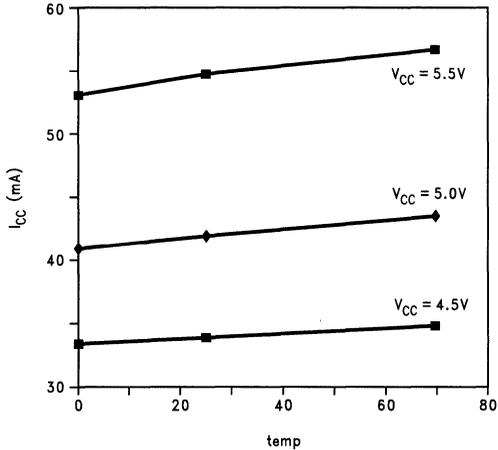
**FIGURE 5. DS3886A I<sub>CC</sub> vs Temperature (All B<sub>n</sub> Outputs Low)**
