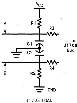
**FIGURE 3. Node Load Circuit**
