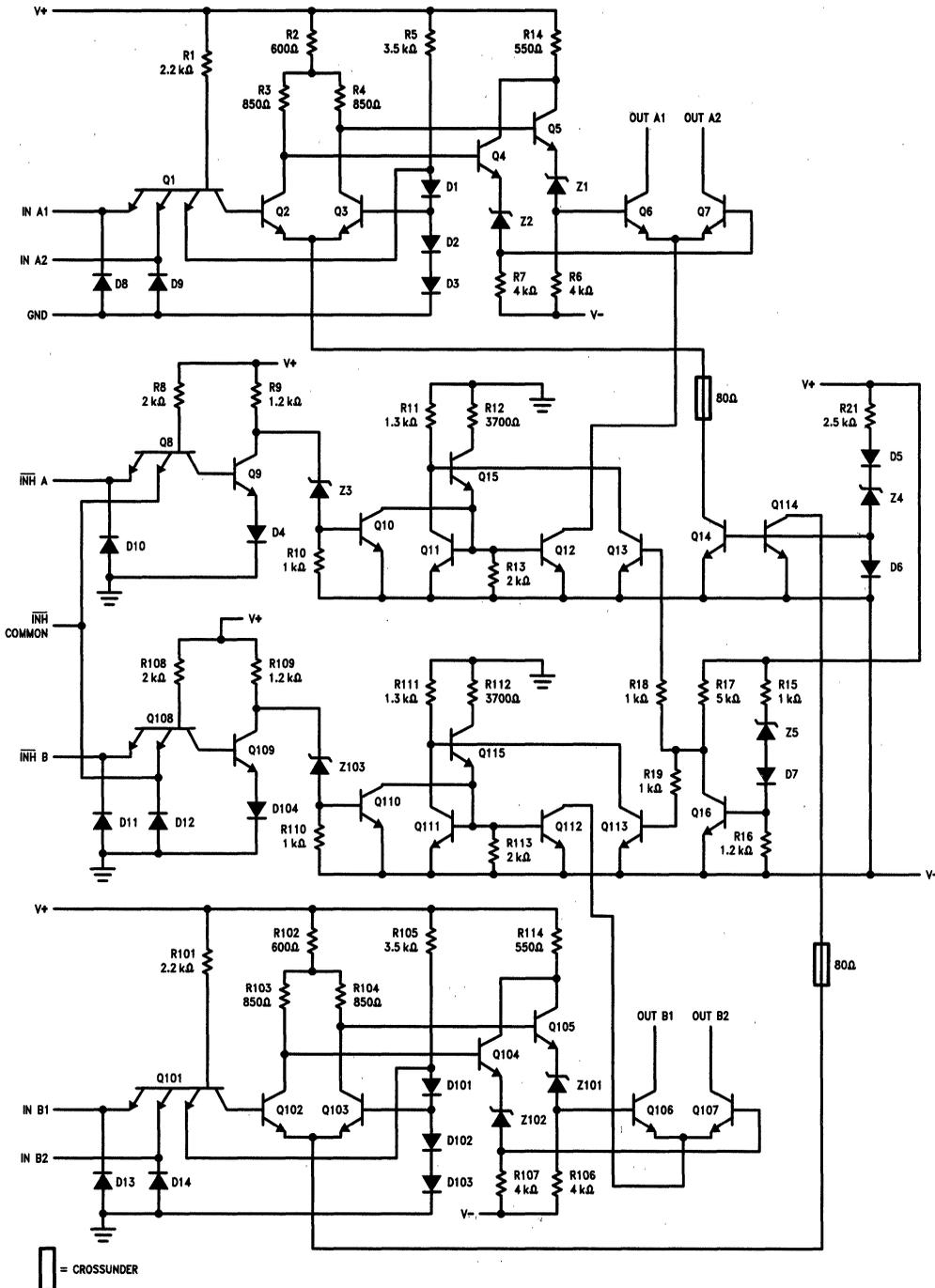
FIGURE 1. Equilent Circuit
