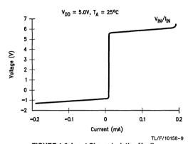
FIGURE 1-6. Input Characteristics  $V_{\rm IN}/I_{\rm IN}$
