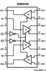
FIGURE 3. DS8921A, DS8922A and DS8923A Connection Diagrams
