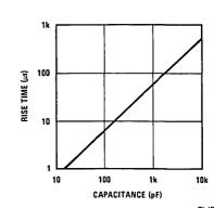
TL/F/5854-15 FIGURE 11. DS3691 Rise Time vs External Capacitor
