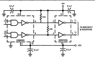
FIGURE 15. DC Coupled Clock Driver Using DH0034
