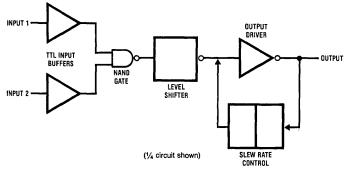
FIGURE 2, DS14C88 Line Driver Block Diagram
