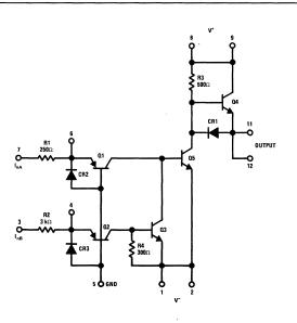
FIGURE 4. DH0035 Schematic Diagram
