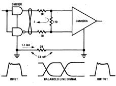
THE GROUND LOOP CURRENT IS MUCH LESS THAN SIGNAL CURRENT
