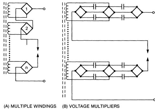
Figure 7. HV Rectifier Schemes
