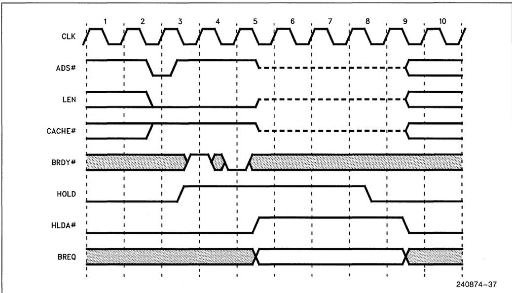
Figure 5.10. HOLD/HLDA Handshake
