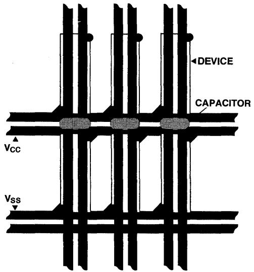
**V<sub>CC</sub>, V<sub>SS</sub> GRID SHOWING DECOUPLING CAPACITORS**
