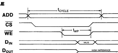
$$\begin{aligned}t_{AA} &= 45\text{ns} \\t_{cycle} &= 45\text{ns} \\t_A &= 45\text{ns} \\t_{WP} &= 25\text{ns}\end{aligned}$$
