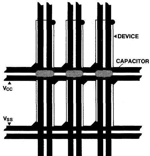
**V<sub>CC</sub>, V<sub>SS</sub> GRID SHOWING DECOUPLING CAPACITORS**
