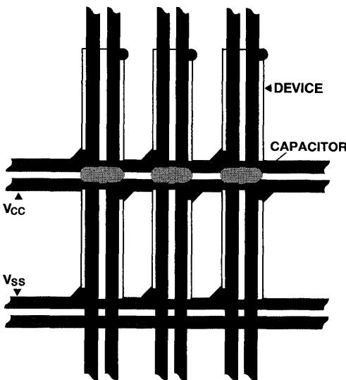
V<sub>CC</sub>, V<sub>SS</sub> GRID SHOWING
