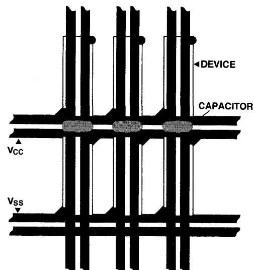
**V<sub>CC</sub>, V<sub>SS</sub> GRID SHOWING
