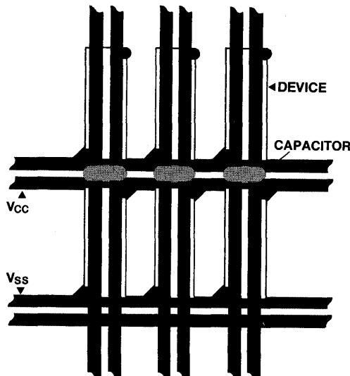
**V<sub>CC</sub>, V<sub>SS</sub> GRID SHOWING DECOUPLING CAPACITORS**
