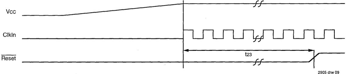
Figure 9. Power-On Reset Sequence
