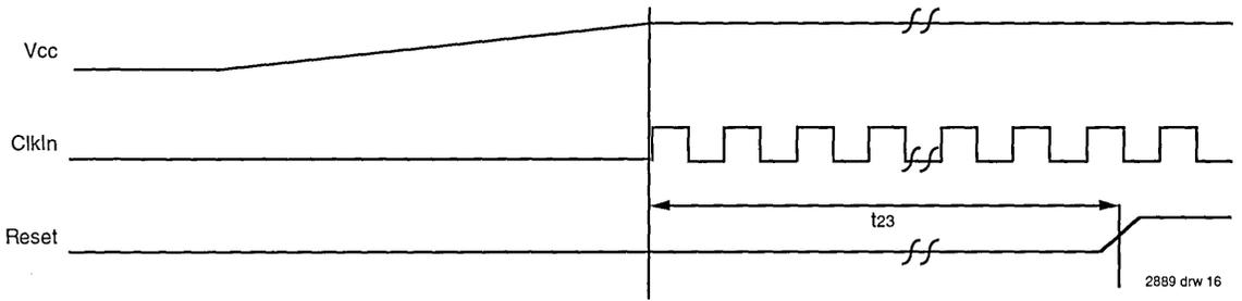
Figure 9. Power-On Reset Sequence
