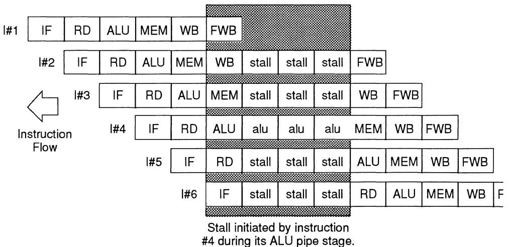
**Figure 3.10. An FPA Pipeline Stall**
