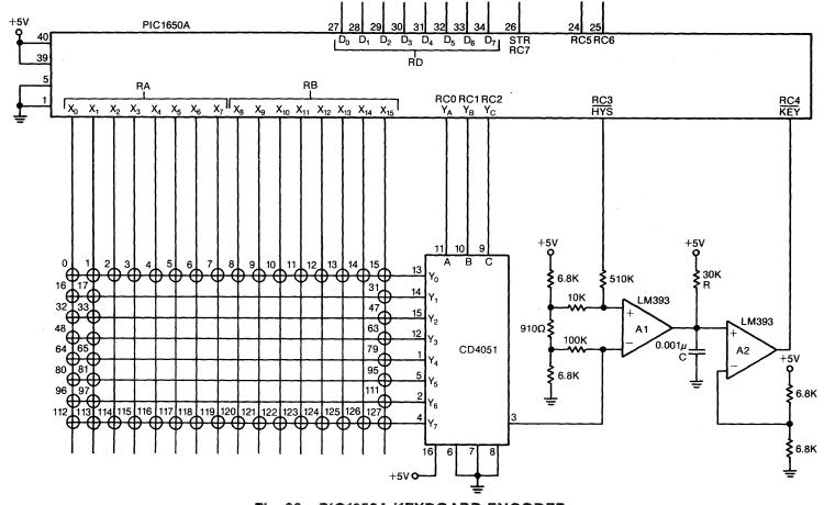
Fig. 26 PIC1650A KEYBOARD ENCODER
