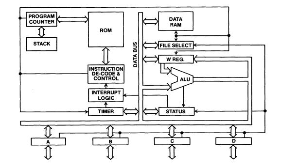
Fig. 5 PIC BLOCK DIAGRAM
