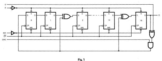
EQUIVALENT CIRCUIT FOR X<sup>16</sup>+X<sup>15</sup>+X<sup>2</sup>+1
