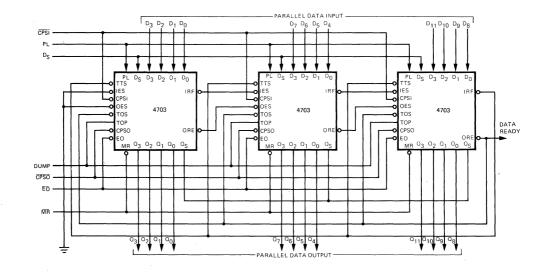
Fig. 5 A HORIZONTAL EXPANSION SCHEME
