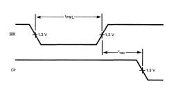
Fig. 3 RESET OPERATION
