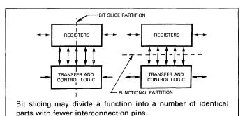
Fig. D-3. Bit Slicing
