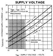
Fig. 4 SUPPLY CURRENT VERSUS
