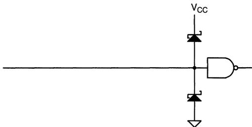
**Figure 19. Schottky Diode Termination**
