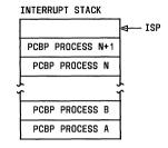
PROCESS B INTERRUPTED PROCESS A. PROCESS N+1 IS LAST PROCESS INTERRUPTED.
