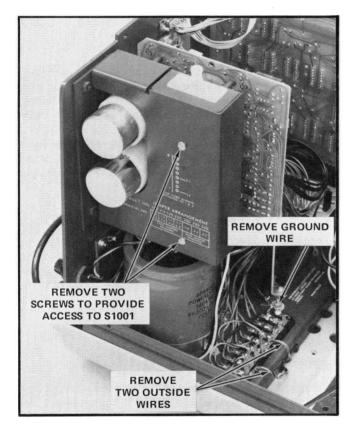
Fig. 3-2. POWER switch wiring.
