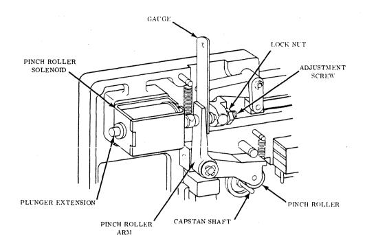
FIGURE 11-1 PINCH ROLLER ADJUSTMENTS
