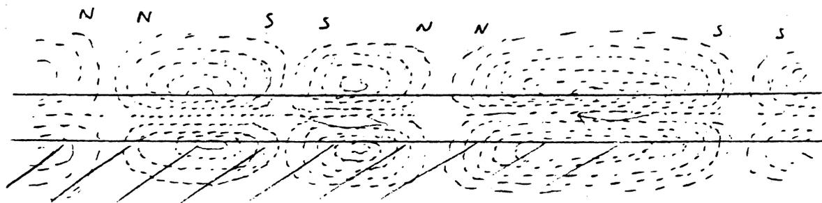
FIG 2.2      TAPE - DISC MAGNETIZATION FIELDS
