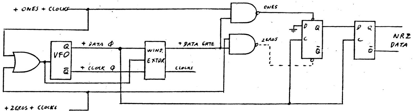
FIG 12-18 PHASE MODULATION DECODER
