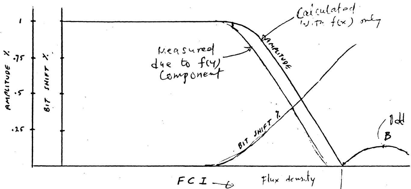
FIG 4.3 TRANSITION DENSITY CURVE
