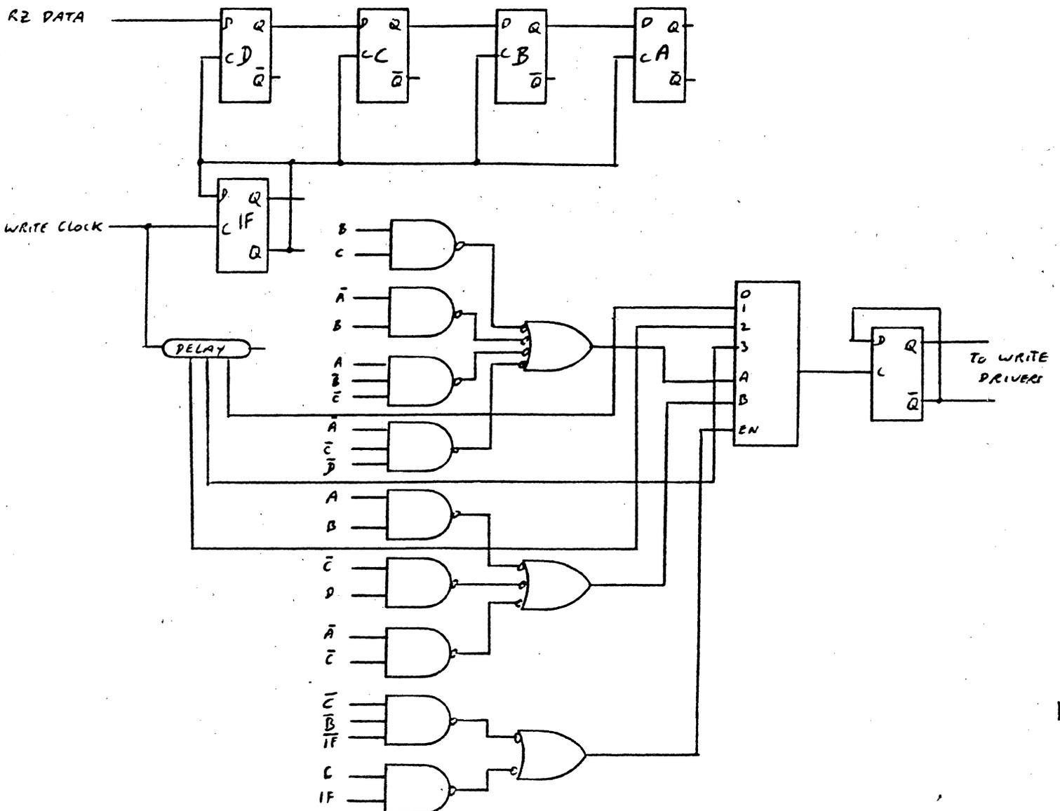
FIG 12.21 M.F.M ENCODER WITH PRE COMP. (3 LEVEL)
