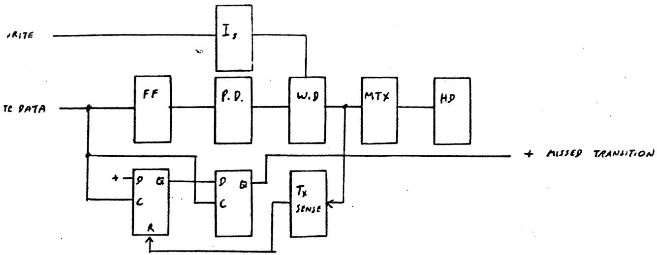
FIG 8.27 MISSED TRANSITION CIRCUIT THAT IS NOT TIME CONSTANT DEPENDENT
