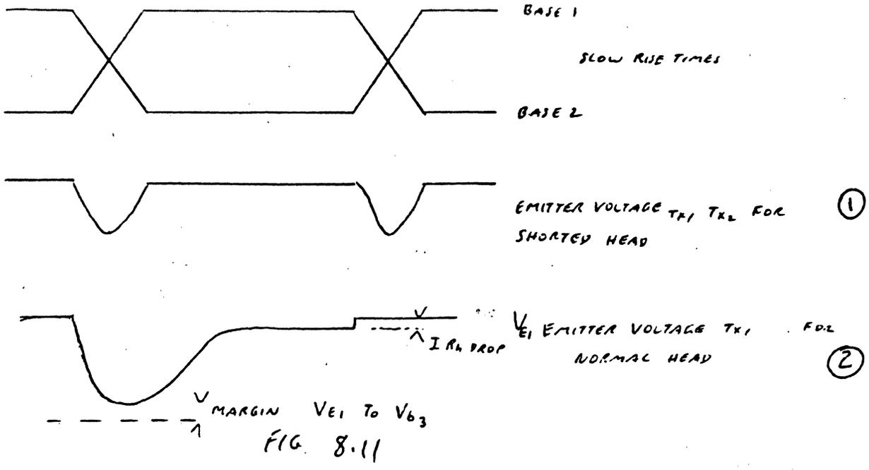
UPPER BRIDGE VOLTAGE WAVEFORMS
