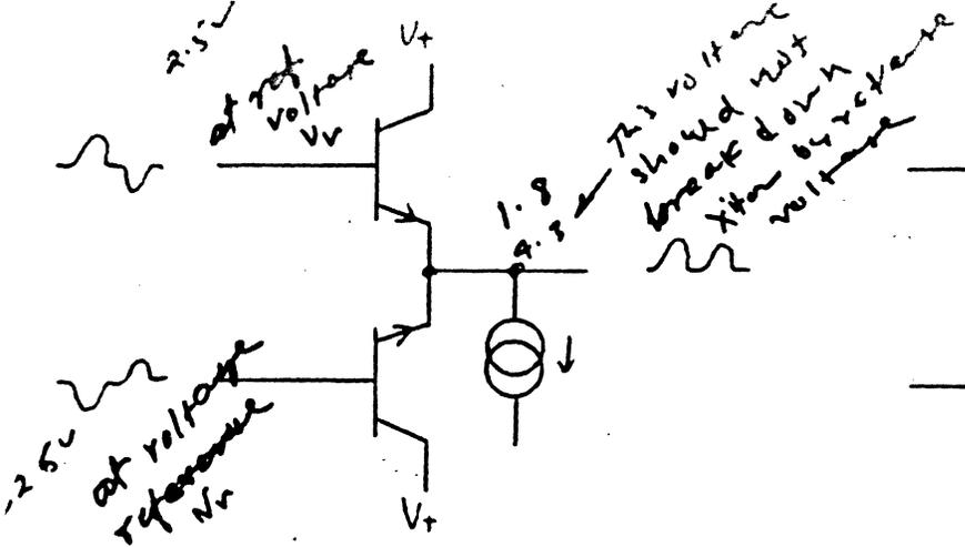
FIG 9.7 TRANSISTOR FULL WAVE RECTIFIER
