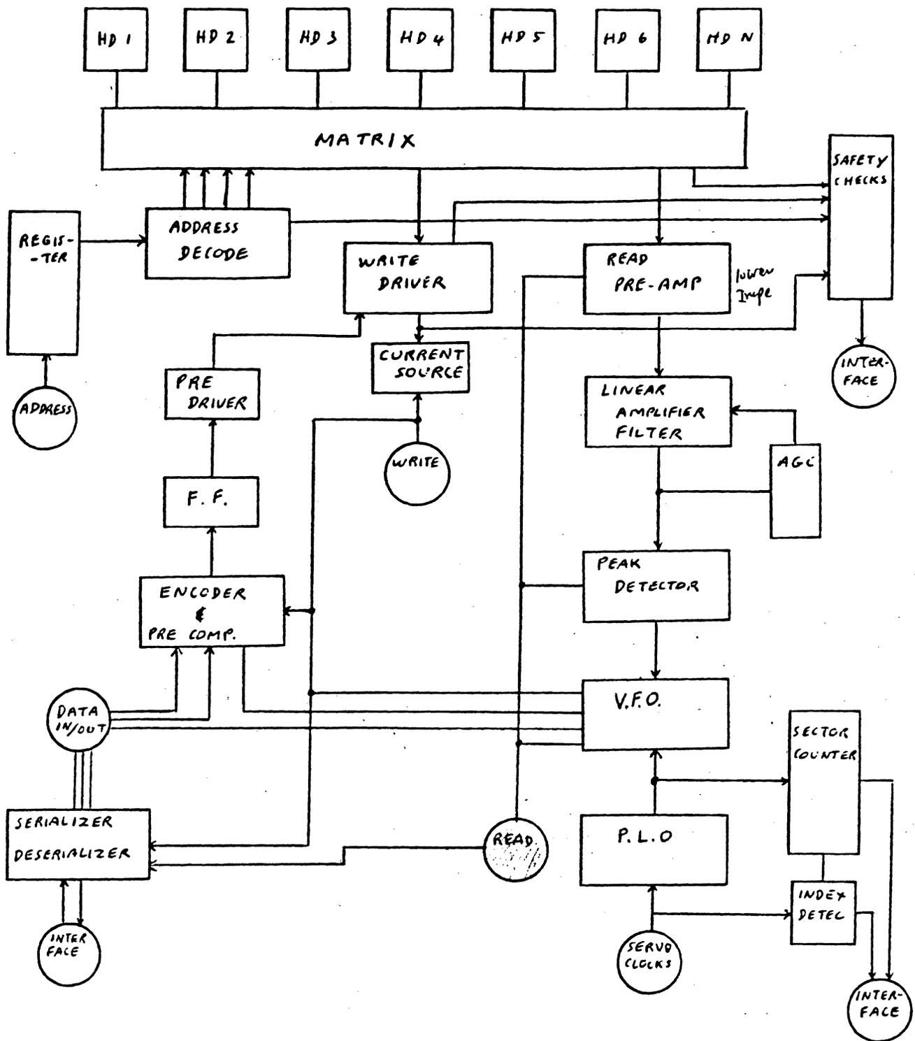
FIG 5-1 TYPICAL R/W BLOCK DIAGRAM
