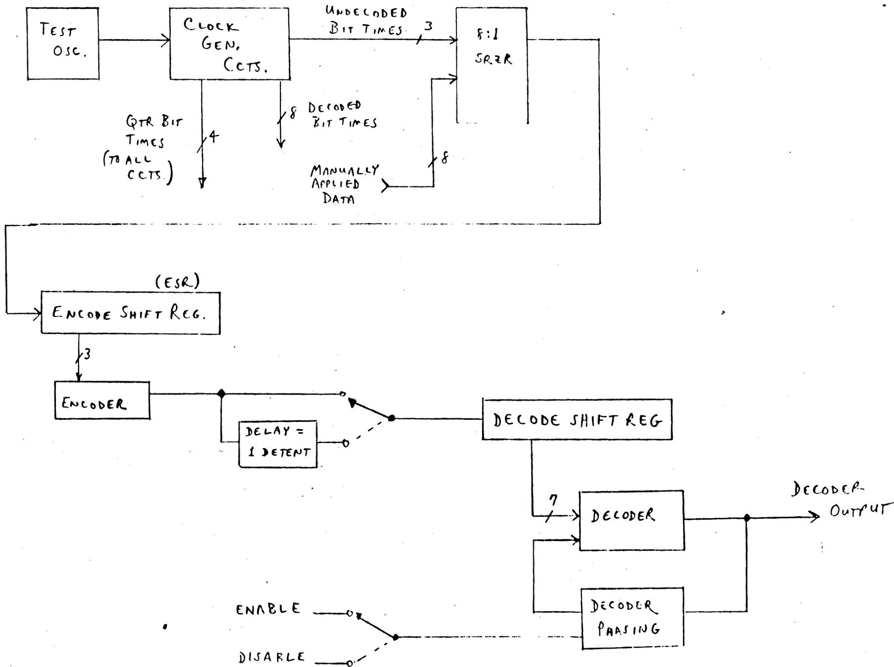
2,7 CODE TEST CIRCUIT BLOCK DIAGRAM
