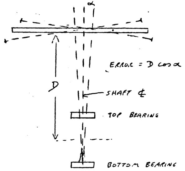
FIG 4-31 DISC TRACK ERROR (RADIAL)
