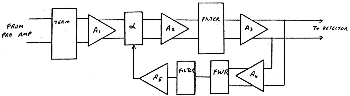
FIG 10.1 BASIC LINEAR AMPLIFIER BLOCK DIAGRAM INCLUDING A.G.C.
