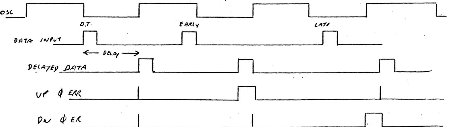
FIG 11.16 B HARMONIC Φ DETECTOR WAVEFORMS
