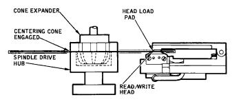
B. CENTERING CONE AND READ/WRITE HEAD LOADED
