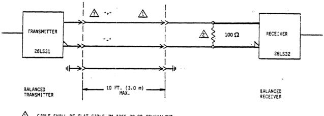
CABLE SHALL BE FLAT CABLE 3M-3365-20 OR EQUIVALENT
