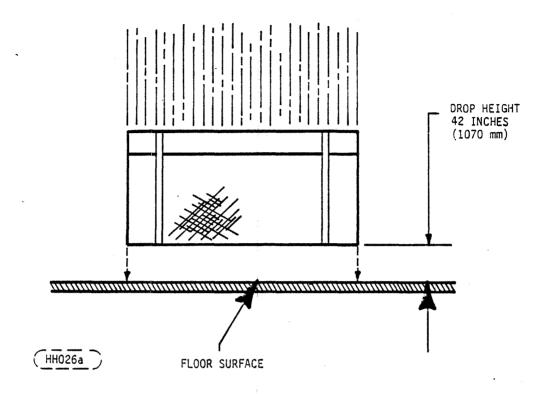
FIGURE 4. FLAT DROP TEST
