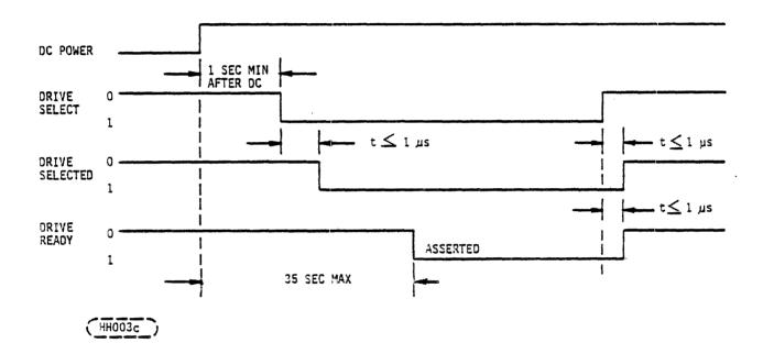
FIGURE 12. POWER TURN ON AND DRIVE SELECTION
