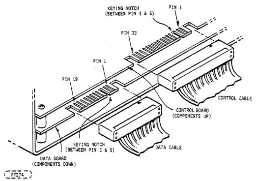
FIGURE 8. CABLE CONNECTION
