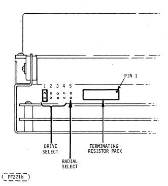
FIGURE 3-6B. DRIVE SELECT AND TERMINATING JUMPER LOCATIONS MODEL 9415-5
