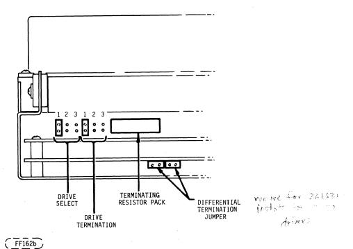
FIGURE 3-6A. DRIVE SELECT AND TERMINATING JUMPER LOCATIONS MODEL 9415-3
