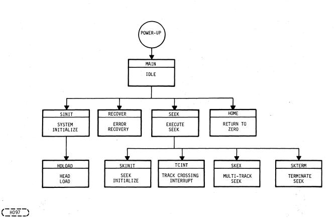
FIGURE 4-8. FIRMWARE MODULE CHART (CDC INTERFACE)
