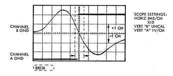
FIGURE LE6-5. EOT WAVEFORMS
