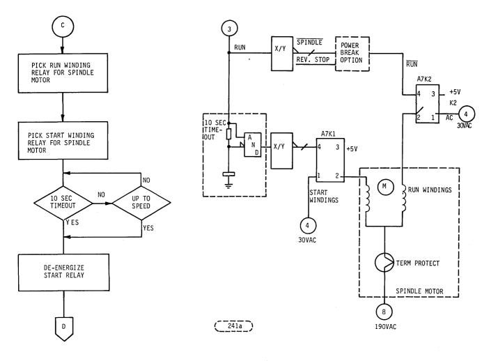
FIGURE 9-3. SPINDLE MOTOR CIRCUITRY
