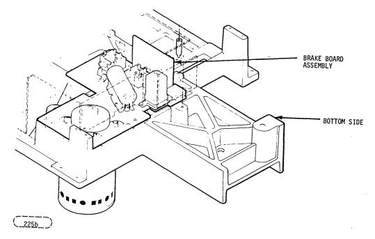
FIGURE 2-8. OPTIONAL BRAKE BOARD ASSEMBLY
