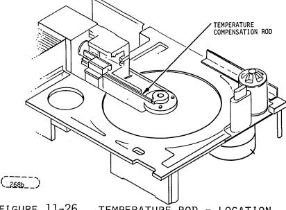
FIGURE 11-26. TEMPERATURE ROD - LOCATION
