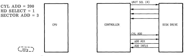
FIGURE 5-13, CONTROLLER SELECT FOR WRITE OPERATION
