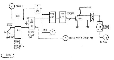
FIGURE 9-2. BRUSH CYCLE LOGIC
