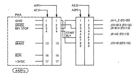
FIGURE 15-14. SPINDLE MOTOR BRAKE (5-23) (SHEET 1 OF 3)
