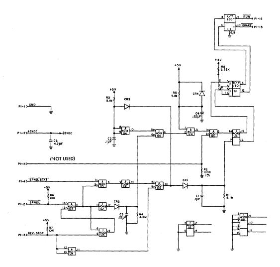
FIGURE 15-14. SPINDLE MOTOR BRAKE (5-23) (SHEET 3 OF 3)
