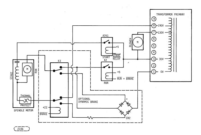
FIGURE 6-3. PRIMARY/MOTOR POWER DISTRIBUTION
