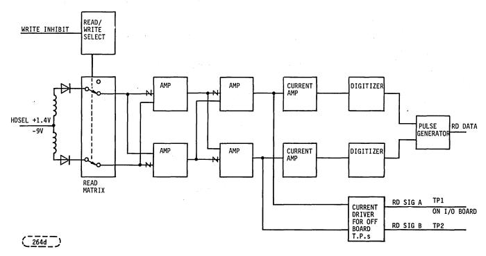
FIGURE 11-10. READ OPERATION AND BLOCK DIAGRAM
