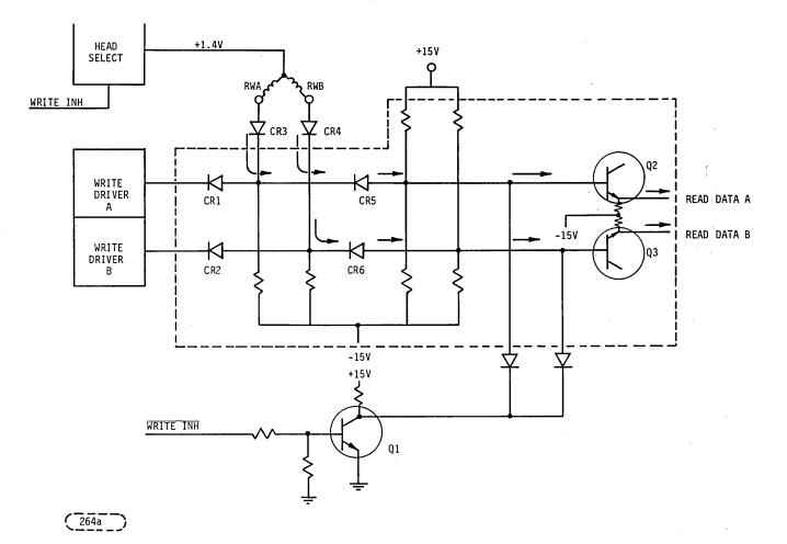
FIGURE 11-8. READ MATRIX BIASED FOR READ OPERATION
