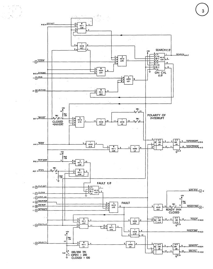
SERVO/VOLTAGE FAULT DETECTION LOGIC
