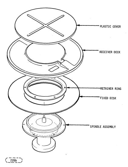
FIGURE 2-10. THE SPINDLE ASSEMBLY
