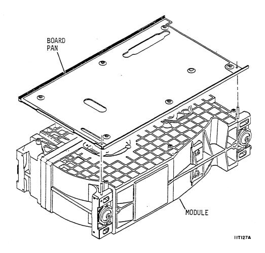
Figure 3-11. Module Replacement
