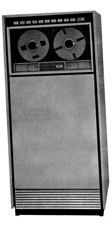
CONTROL DATA 601 TAPE TRANSPORT WITH 1731-A/B MAGNETIC TAPE CONTROLLER
